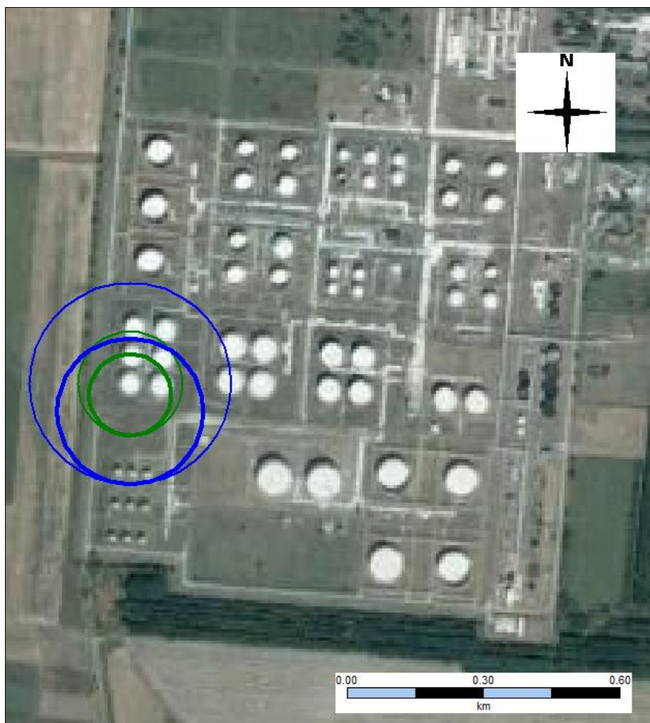
6.3.2.2.1.5. ábra A3 - Tócsatűz – hőszugárzás
