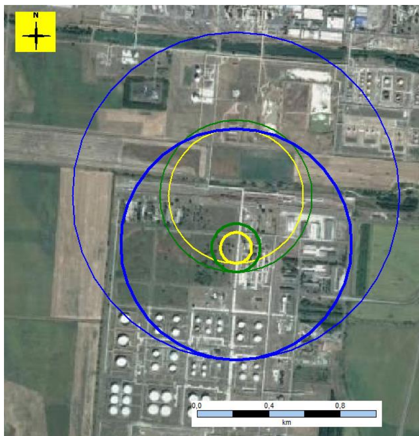
6.3.5.12.5.1.4. ábra L1 – VCE – kései gyújtás nyomáshatásai
