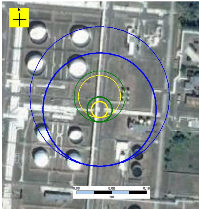
6.3.5.8.3.1.2. ábra H2 – VCE – kései gyújtás nyomáshatásai
