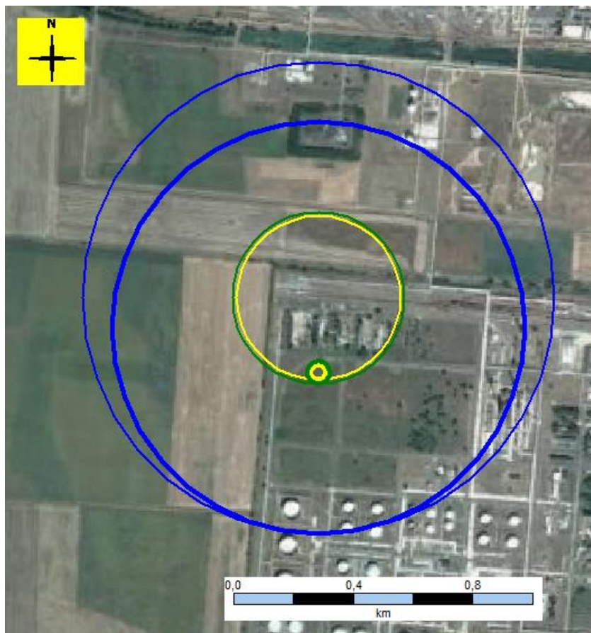
6.3.5.10.3.1.4. ábra J1 – VCE – kései gyújtás nyomáshatásai
