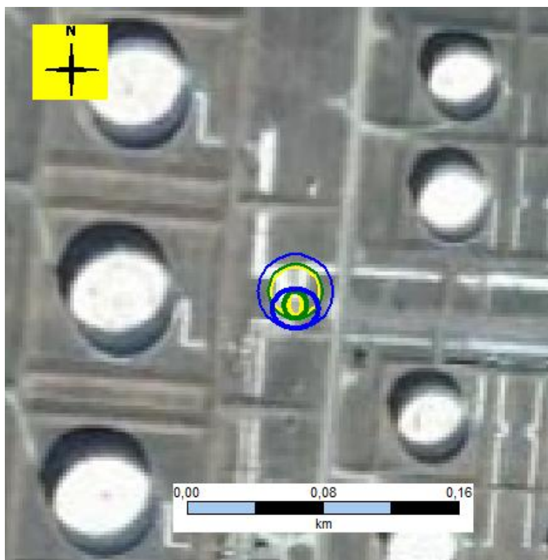
6.3.5.6.2.1.3. ábra F1 - Jettűz - hőszugárzás
