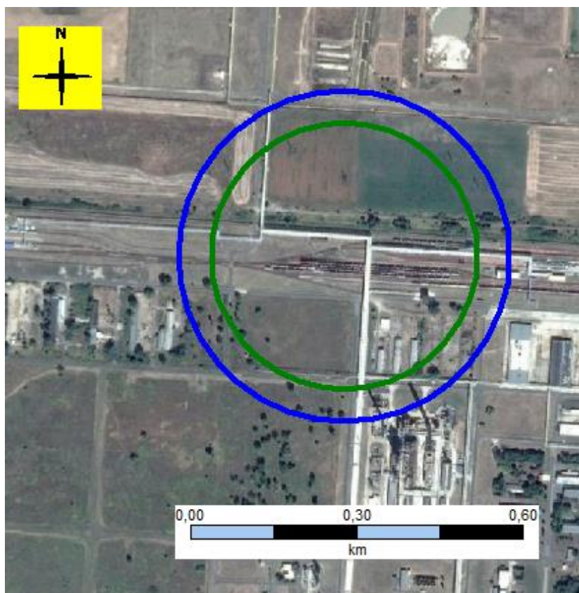
6.3.5.12.5.1.2. ábra L1 eseménysor Gőztűz - hőszugárzás
