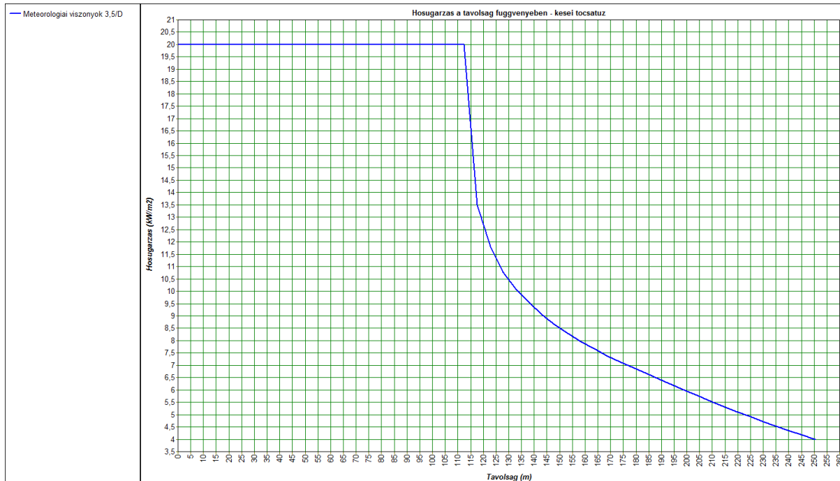
F1.3. ábra: TIT_F1_Gőz+KTócsa (Hőszugárzás vs. távolság – Kései tócsatűz)
