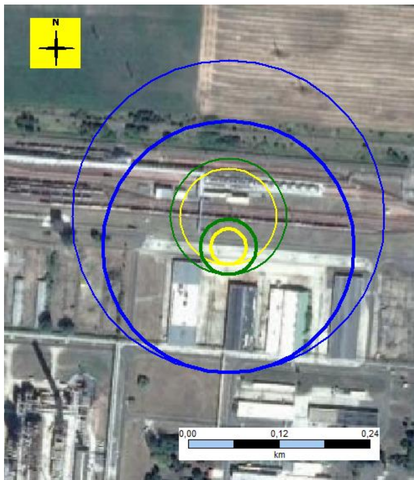
6.3.5.13.3.1.5. ábra M2 – VCE – kései gyújtás nyomáshatásai
