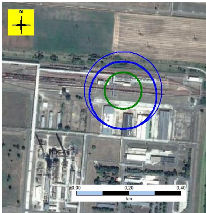
6.3.5.13.3.1.2. ábra M1 – Kései tócsatűz – hőszugárzás
