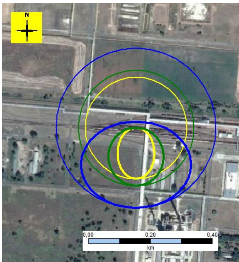
6.3.5.12.5.1.5. ábra L2 - Jettűz - hőszugárzás
