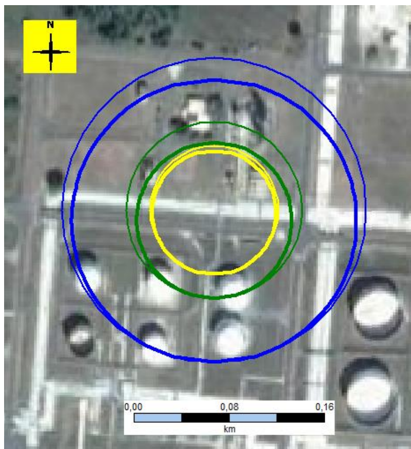
6.3.5.9.2.1.5. ábra I1 – Kései tócsatűz – hőszugárzás
