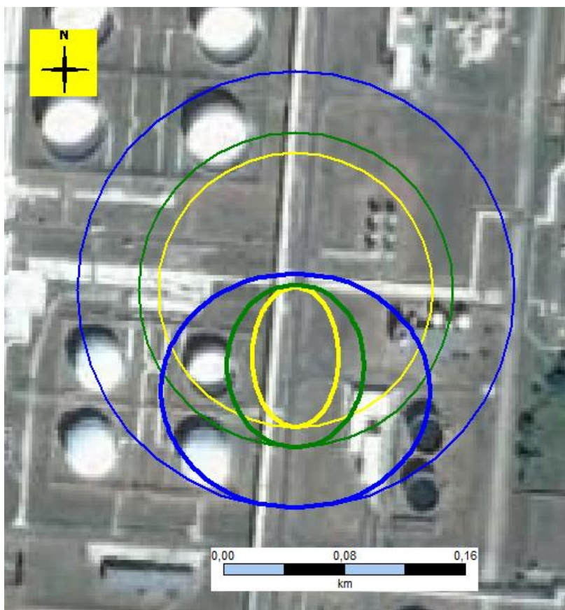
6.3.5.7.2.1.3. ábra G1 - Jettűz - hőszugárzás
