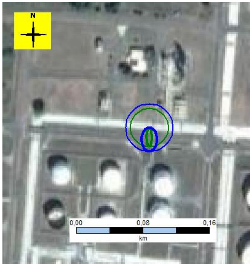
6.3.5.9.2.1.3. ábra I1 - Jettűz - hőszugárzás
