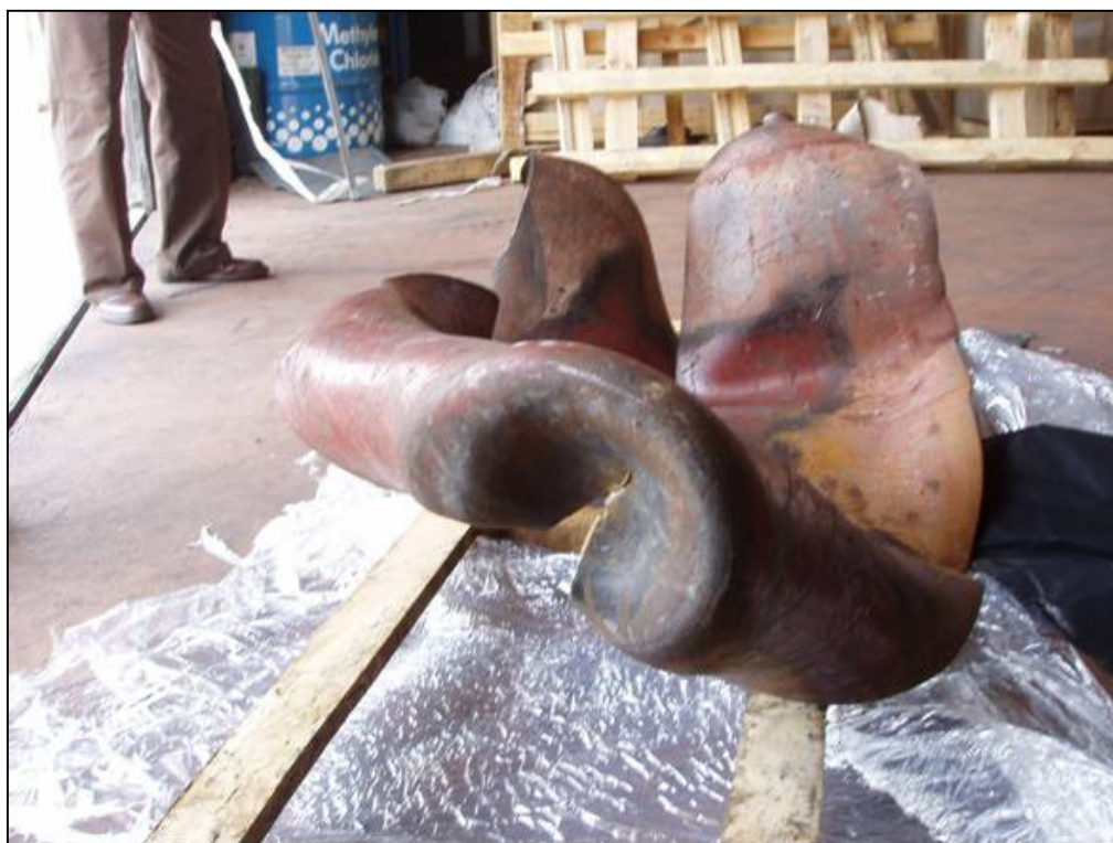
1. ábra: Palack felhasadása
