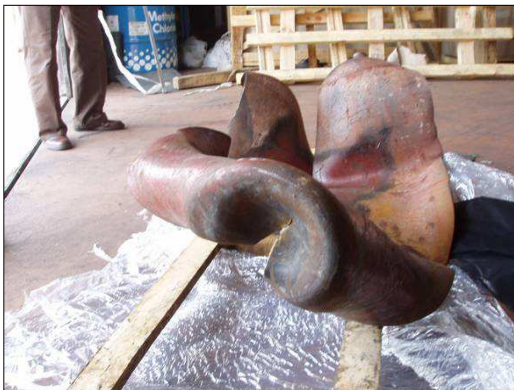
1. ábra: Palack felhasadása
